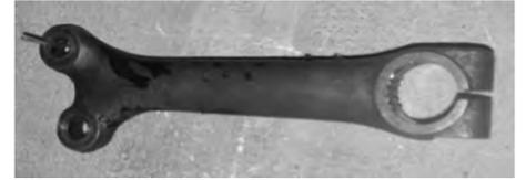
Es wurde wahrscheinlich Ende der fünfziger Jahre die Lenkung von rechts auf links umgebaut, ohne Austausch des Lenkstockhebels, und 40 Jahre mit dem falschen Hebel gefahren. Um ein Radieren der Räder zu vermeiden, wurde vorne ein Bleigewicht mit 55 kg eingebaut, das jetzt nicht mehr notwendig ist.
