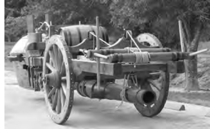
Das Geschützrohr wurde mit Seilwinden von unten in den Rahmen gehoben und so transportiert
