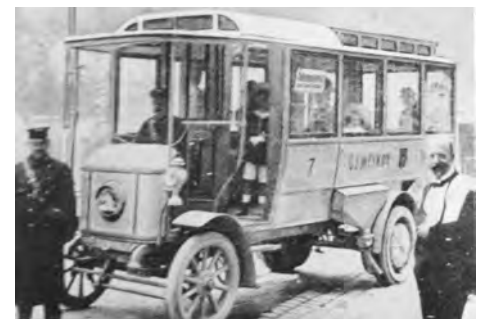
Bild oben: Oberleitungsautomobil System „Mercedes Electric“ Wien 1908
