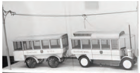
Bild oben: Modell des Oberleitungsautomobils mit Allradantrieb + Anhänger - in der „Remise“ Wien. Für die Strecke von Pötzleinsdorf nach Salmansdorf mit einer Steigung von bis zu 10% wurden um 1910/11 versuchsweise Oberleitungsautomobile mit Allradantrieb und einem Anhänger eingesetzt.
